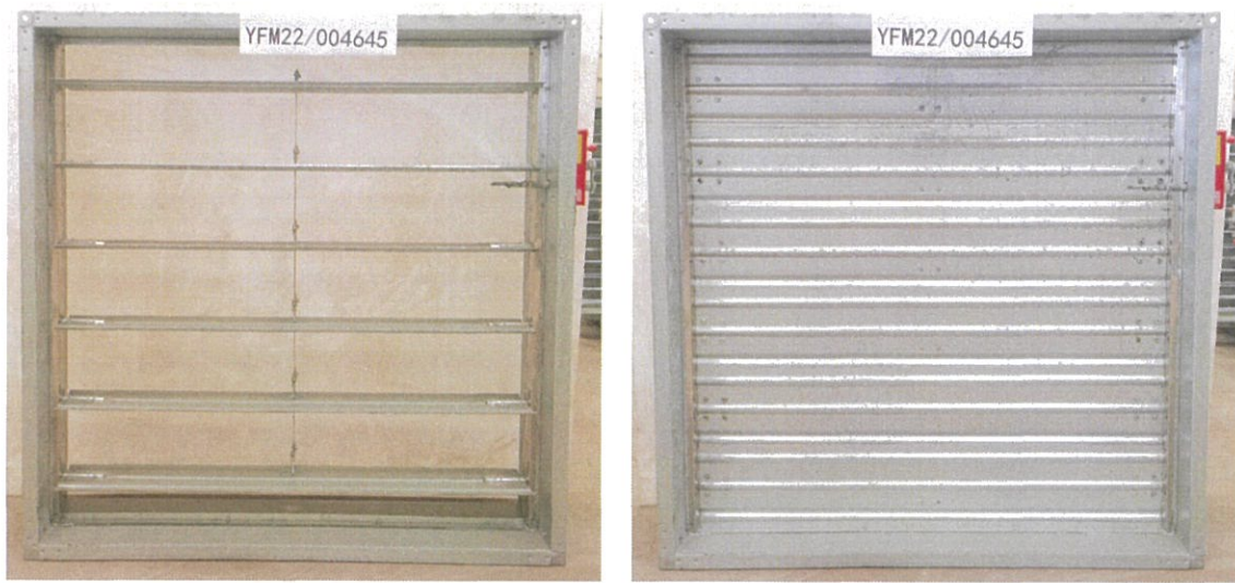
照片 1 耐火性能试验前试件情况
