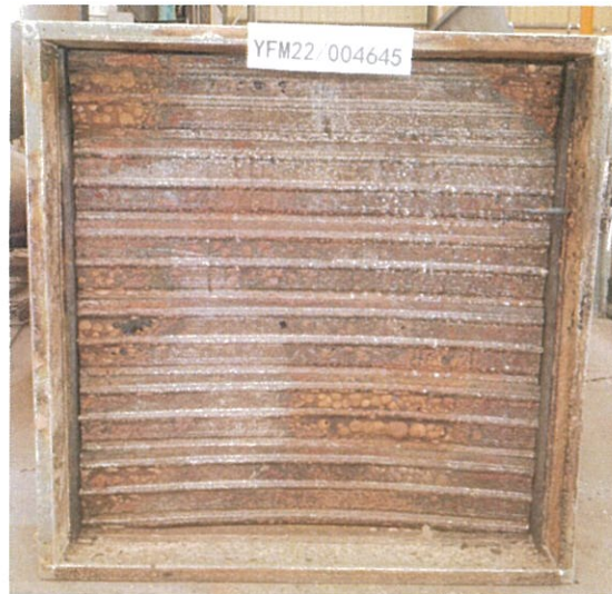
照片 2 耐火性能试验结束时试件情况
