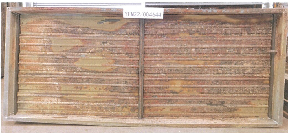
照片 2 耐火性能试验结束时试件情况
