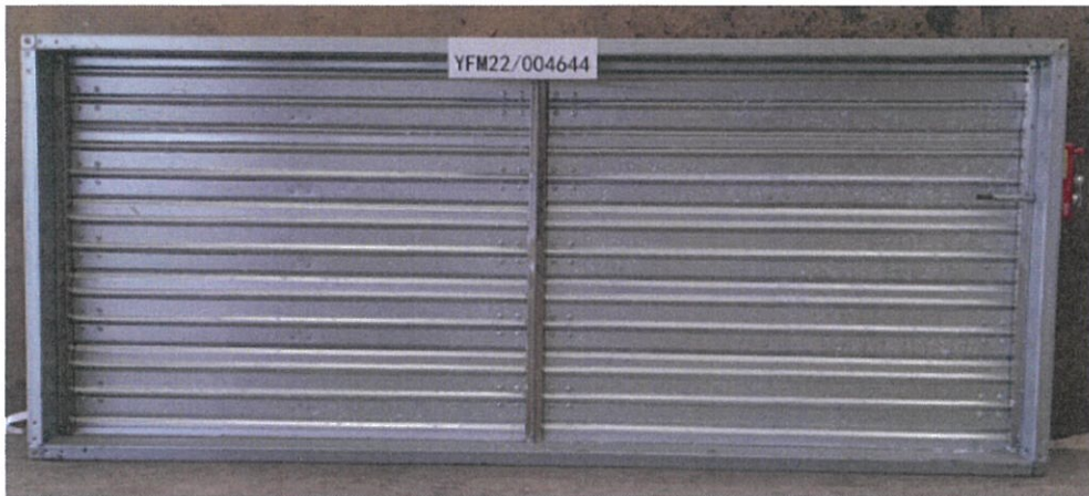
照片 1 耐火性能试验前试件情况
